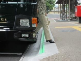
バリアフリー車両の導入 バス停への正着を促進する縁石
