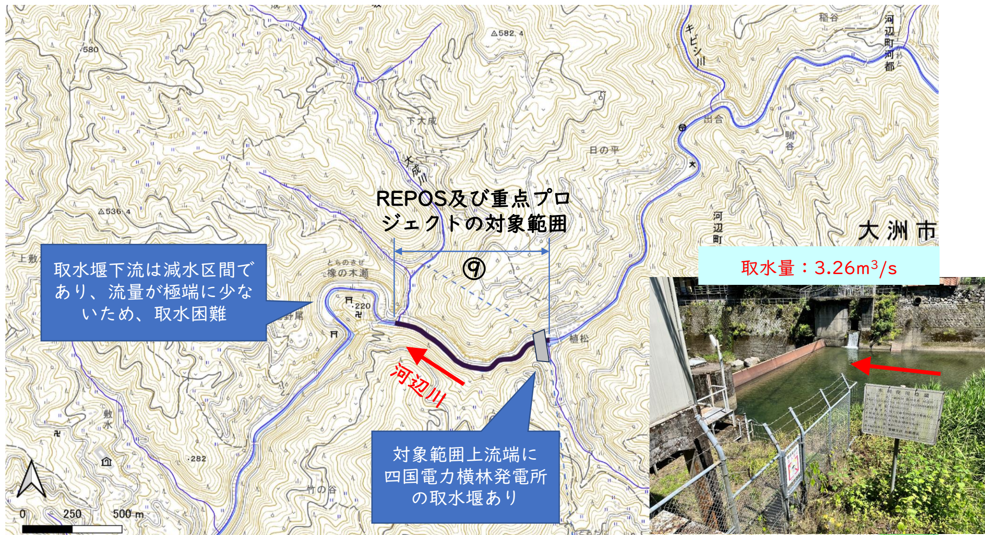
図 事業実施困難箇所の例①（既設発電所の減水区間）
