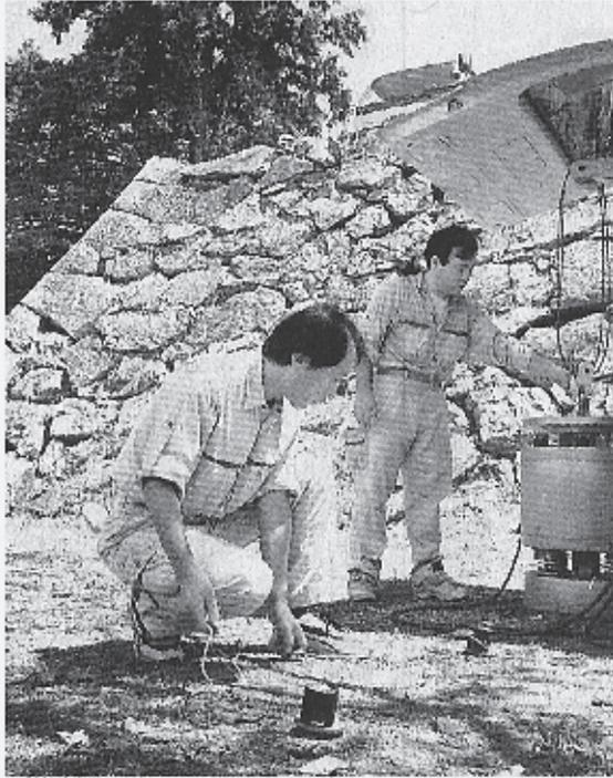
探査器具を使って石垣や内部構造などを調査する作業員
