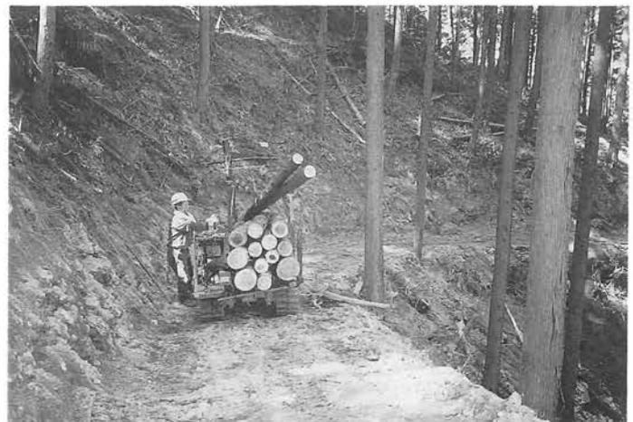
林内作業車道を使用して間伐林の集材搬出作業
