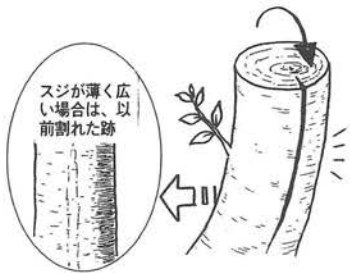
この縦スジは、風などの力を受け、斜めになった木の凸側が押しつぶされて材が割れた跡です。
