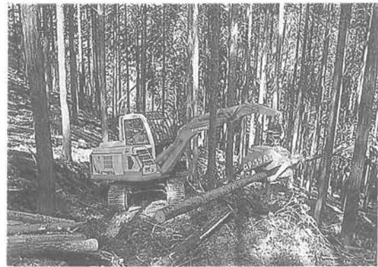
高性能林業機械を使った枝払い・玉切り作業 (プロセッサ)
