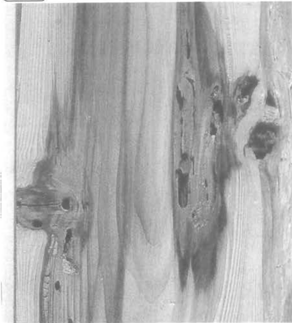
写真6 ■材内被害の“トビクサレ”
