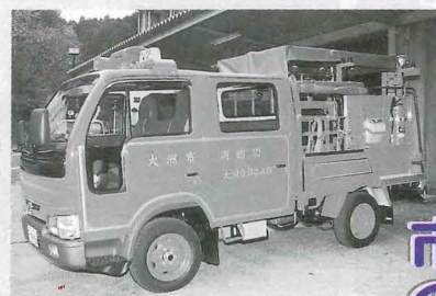
▲消防施設整備事業で購入された小型動力ポンプ積載車
