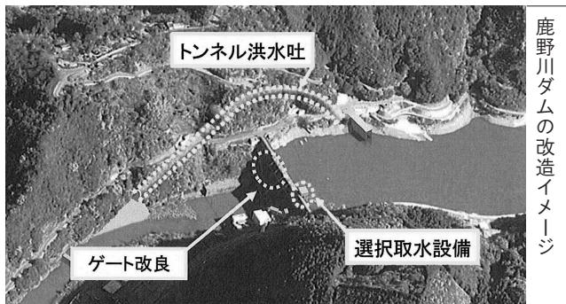
冷水の放流と底泥の流出については、曝気装置による貯水池内のかくはんにより、トンネル洪水吐きの呑み口の高さの水温を表層に近い水温に改善することで対応すると伺っています。また、ダムの河床より10メートル程度高い位置に呑み口を設置するとともに、呑み口部の導水路についても周囲の底泥を引きこまない構造とすることで対応が可能と考えられています。
