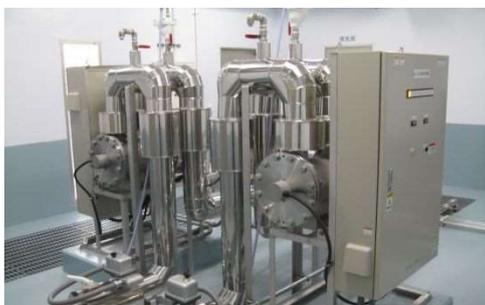
紫外線照射装置（装置外観）
