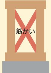
耐力壁(筋かいや構造用パネル)の量を
