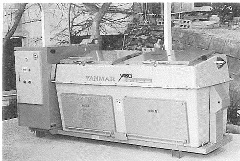
ゴミ減量のため導入した生ゴミ処理装置
