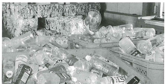
▲回収されたペットボトルは500本程の固まりに圧縮されリサイクル施設へ運ばれる
